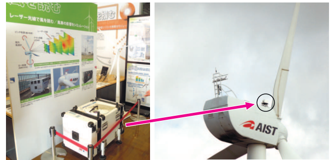
レーザー光による風向・風速をリモート計測する装置
