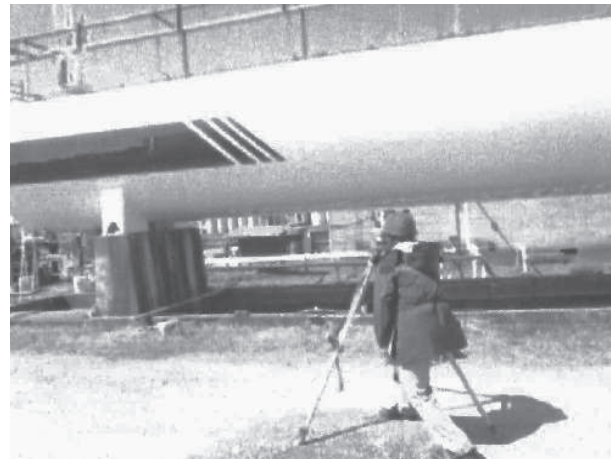
図3-10 貯槽基礎不同沈下測定
