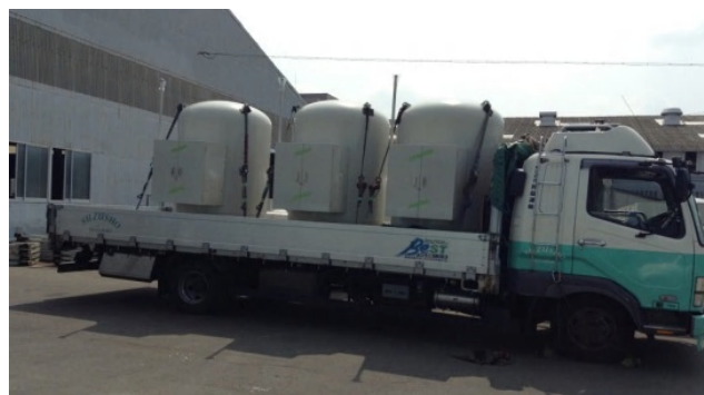
バルク貯槽移送基準による複数移送
